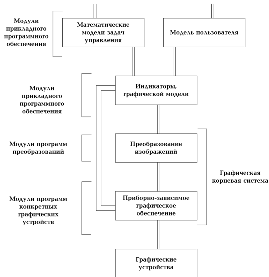
Рис. 3.1.1. Структура математического обеспечения графической системы
